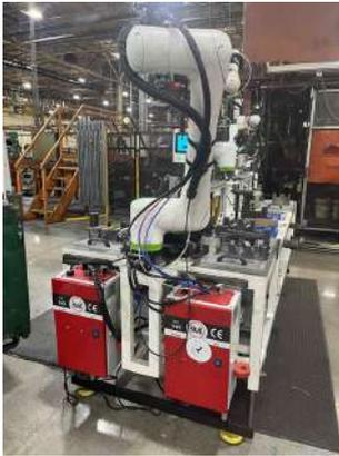
*Per una soluzione integrata, modulo più booster, nella quale l'operatore umano esegue il fissaggio, RIV949 è la rivettatrice oleopneumatica di Rivit per inserti ideale.*
