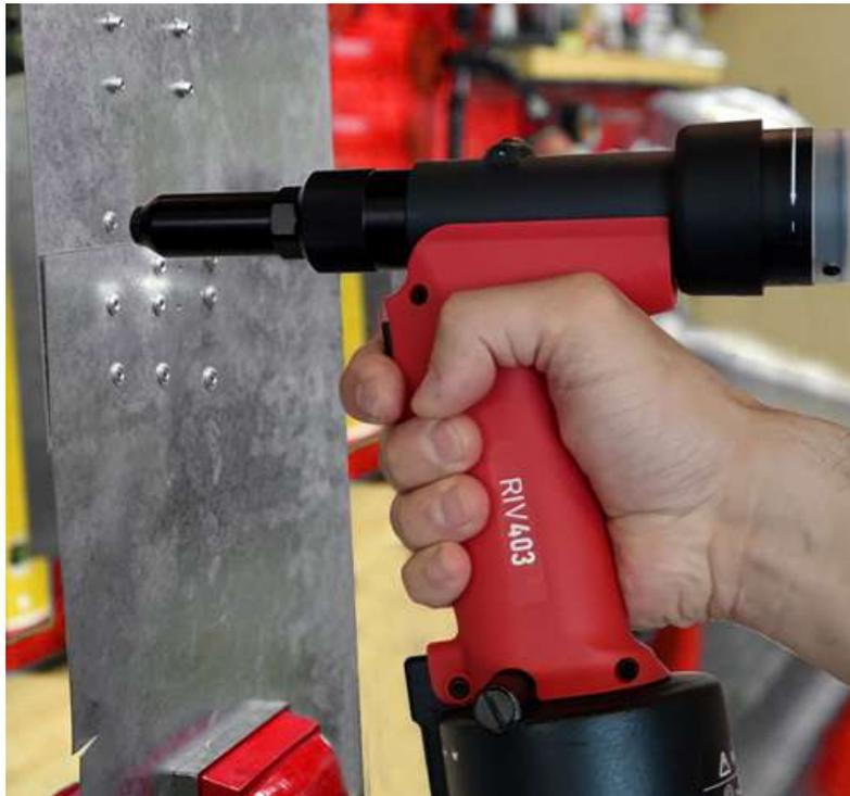
*Le rivettatrici oleopneumatiche della serie 400 sono progettate per il fissaggio di rivetti di diverse dimensioni sui materiali più diffusi. Nella foto il modello RIV403.*
