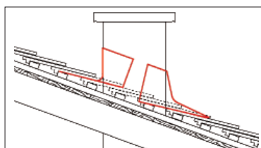
Piastra per inclinazioni da 40 a 50 gradi. For roof slopes from 40 to 50 degrees.
