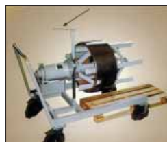
Attraverso l'apposita maniglia si alza all'altezza desiderata ed è pronto per l'utilizzo. Using the proper handle you can adjust the height and than it is ready to be used.
