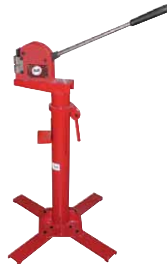
Completa di morse per ricalcare e stirare, con cavalletto. Features vice to trace and stretch, with trestle.
