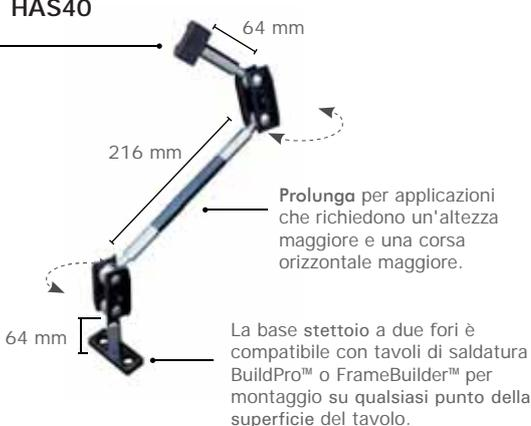
Testa con apertura adattabile da 19 mm, scanalata, accetta pinze e strettoi per bloccare materiale tondo, piatto, quadrato o angolato. Due viti bloccano in modo sicuro i pezzi o i strettoi in posizione.
