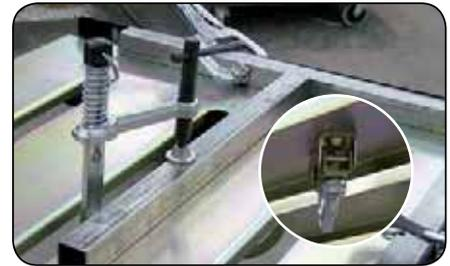
Gli strettoi MagSpring possono essere inseriti nelle scanalature da 28 mm sul piano del tavolo Nomad per il bloccaggio.
