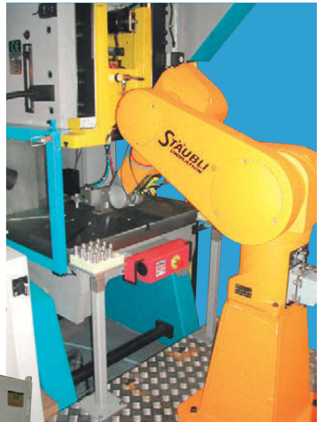
Presse 25 T avec chargement automatique robotisé
