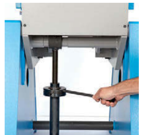
Réglage de l'inclinaison (hydraulique sur 45 et 80T)
