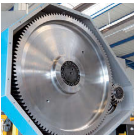
Vue de l'ensemble pignon roue dentée de la 80t
