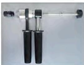
Установите требуемые по размеру шпильку и головку в инструмент.
