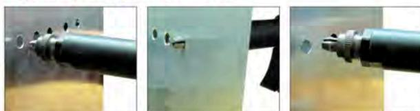
RIV991 поставляется в пластиковом контейнере без пробойника и патрона. Выберите необходимый пробойник и патрона в соответствии с размером устанавливаемой заклепки (см. таблицу ниже).
