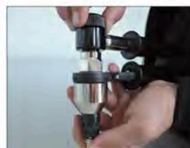
Подвиньте нижнюю рукоятку против часовой стрелки и выверните шпильку из заклепки.
