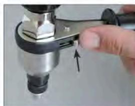
Для извлечения инструмента передвиньте переключатель.
