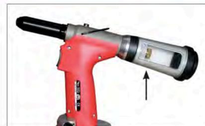
Ручка регулировки силы всасывания.
