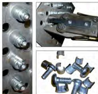
Комплект используется для снятия установленного болта.
